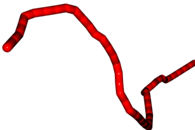
Obrázek 2.5: Tunel zobrazený pomocí středové linie.
