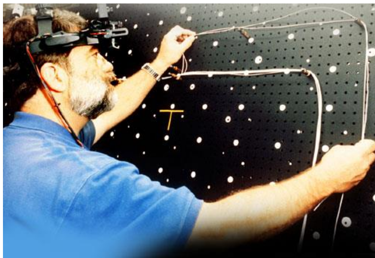
Obr. 2 Využití AR při montování kabelů do boeingu
